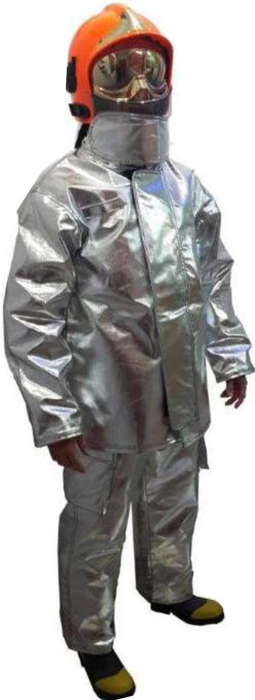
Construido en tejido aluminizado de 8Oz. Con costuras de alta resistencia, este equipo para aproximación otorga gran resistencia térmica y destreza. Constituido por chaquetón, pantalón y tiradores es la mejor opción para tareas con gran carga térmica. Bolsillos en interior del chaquetón y en ambos lados del pantalón. Barrera térmica de alta resistencia respirable y transpirable
